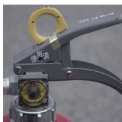
× 表示装置の脱落
