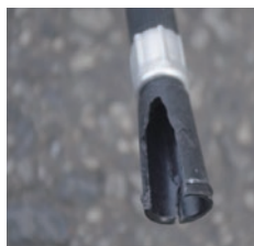
× ノズルの破損
