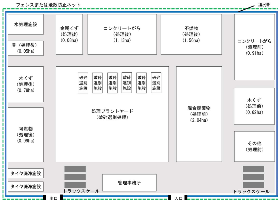
図表 3-2-11 機械選別等を行う二次仮置場のレイアウトイメージ
