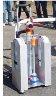
スタンドパイプ
